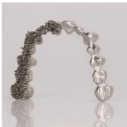
14-delige brug met lasersinterprocedé geproduceerd; linkerkant incl. supports, rechterkant supports verwijderd en gepolijst
