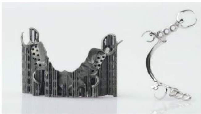
Fig. 4 Scheletrato realizzato con sinterizzazione laser – con strutture di supporto - scheletrato finalizzato (immagine in alto) - scheletrato finito inserito su modello in resina (immagine in basso) Fonte: EOS, INFINIDENT Solutions
