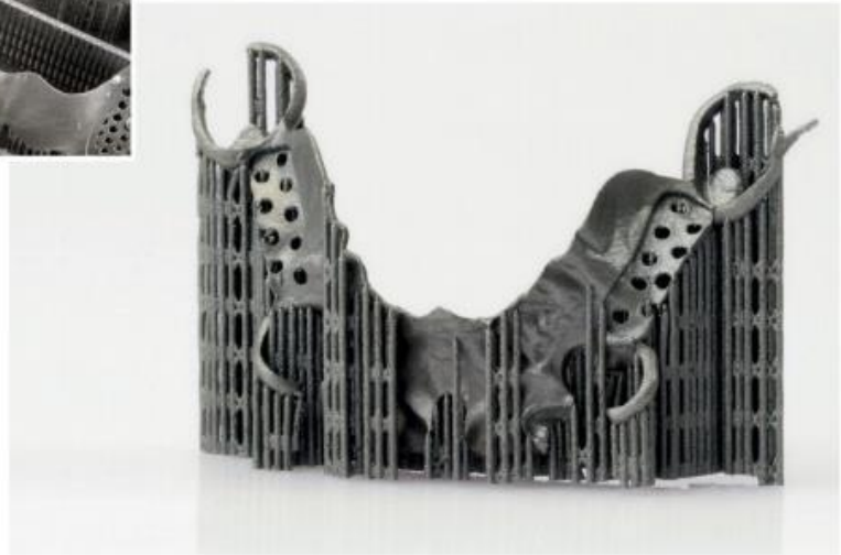
Fig. 9 Scheletrato con strutture di sostegno dopo cottura di sollievo dallo stress (Fonte: EOS)
