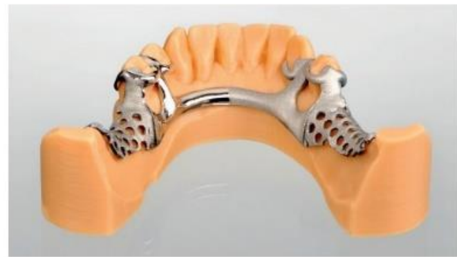
Fig. 4 Scheletrato realizzato con sinterizzazione laser – con strutture di supporto - scheletrato finalizzato (immagine in alto) - scheletrato finito inserito su modello in resina (immagine in basso) Fonte: EOS, INFINIDENT Solutions
