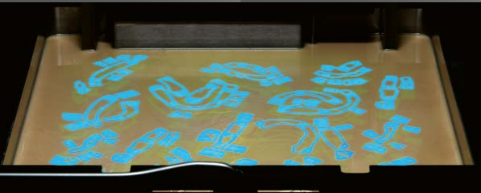
Bei Infinident kommen für den 3-D-Druck unter anderem das effiziente und präzise Stereolithografie- sowie DLP-Verfahren mit Langzeitbelichtung zum Einsatz.
