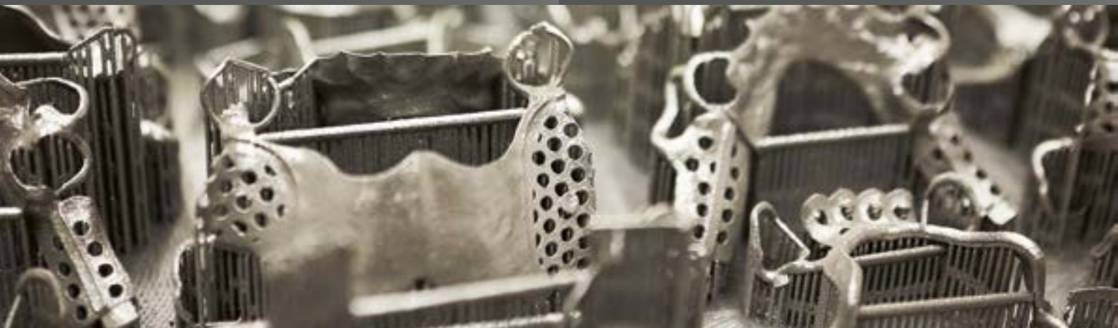
Bauplatzform mit im SLM-Verfahren hergestellten dentalen Strukturen. Diese Aufnahme verdeutlicht das große Potenzial dieser Fertigungstechnologie: hohe Stückzahlen und somit geringe Stückkosten.
