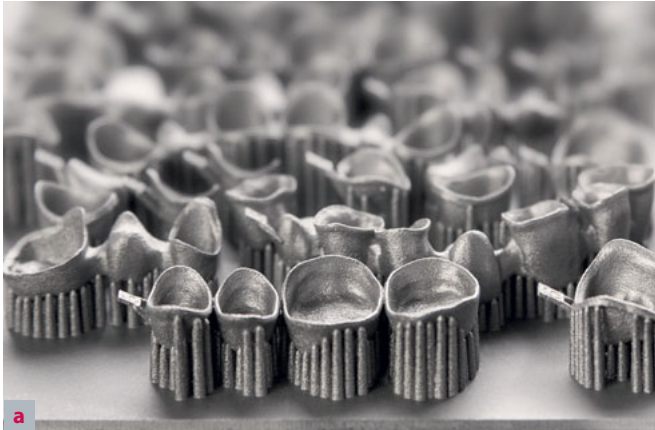
Abb. 2a und b Bauplattform mit Kronen und Brückengerüsten (links, Foto: EOS) sowie Modellgussprothesen (rechts, Foto: Infindent Solutions) auf einer EOS M270. Das System ist speziell für die Produktion von Dentalapplikationen in großen Stückzahlen konzipiert.
