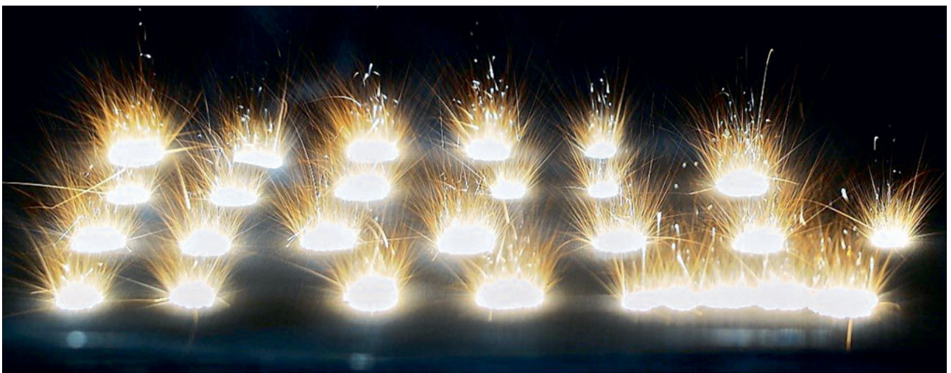
Abb. 3 EOS M270 Baujob – Laserschmelzvorgang innerhalb der Baukammer – mit einem 200 Watt Yb-Faserlaser.
